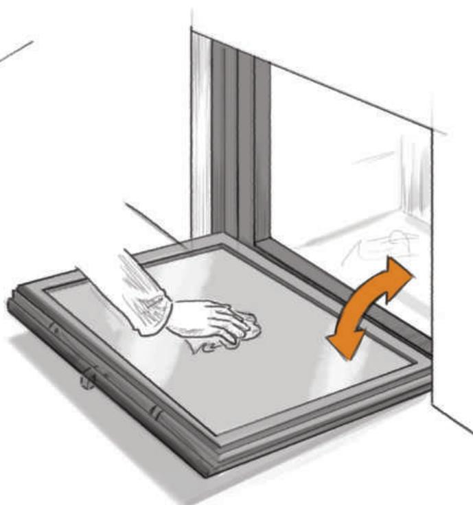
Para permitir la limpieza y el mantenimiento de la ventana, el marco se balancea, sin necesidad de desmontarlo.
