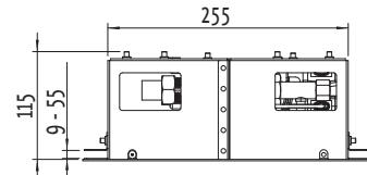
Para realizar operaciones de mantenimiento periódicas, su Fairo ECO-prestige es fácilmente accesible gracias a la caja técnica, que se puede colocar dentro de un rango de 4 m desde el lado izquierdo del hogar mediante un tubo flexible de gas.
