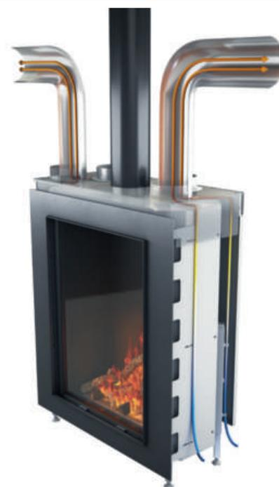
+ Todos los hogares tulp están diseñadas para ser conectadas con tubos concéntricos de acero inoxidable. Los aparatos son herméticos y recogen el aire necesario para la combustión a través del canal periférico del conducto. Este aire se calienta en contacto con el tubo interior del conducto de salida de humos.
