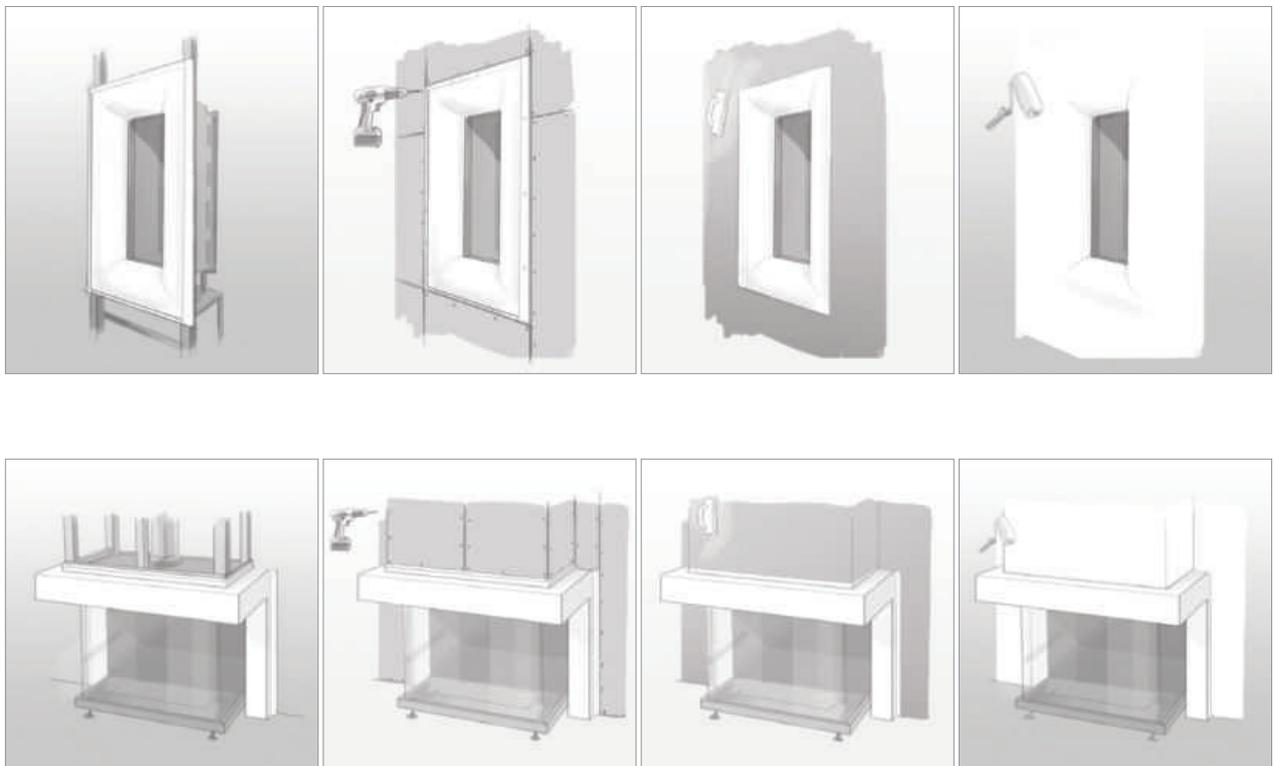
Under-Cover... Lo que se puede ver: un hermoso hogar con formas totalmente curvas, perfectamente integradas en la decoración y la arquitectura. Lo que no se puede ver: las estructuras construidas en un compuesto ecológico resistente al calor. Sus marcos, perfectamente integrados en la pared y que evitan las grietas alrededor del hogar, son ligeros y fáciles de aplicar. Y dado que la capa superior se puede cubrir, le resultará fácil pintarlos del color que usted prefiera.
